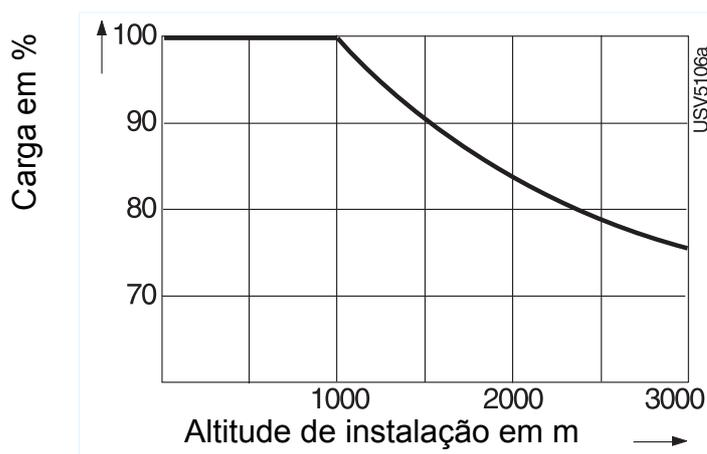
Figura 3 - Carga admitida dependente da altitude de instalação
